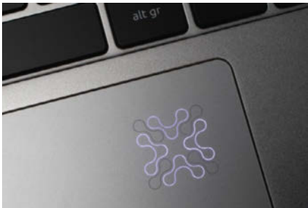
Acer baut ins Touchpad eine LED-Anzeige ein, die immer dann leuchtet, wenn eine App die NPU nutzt.
